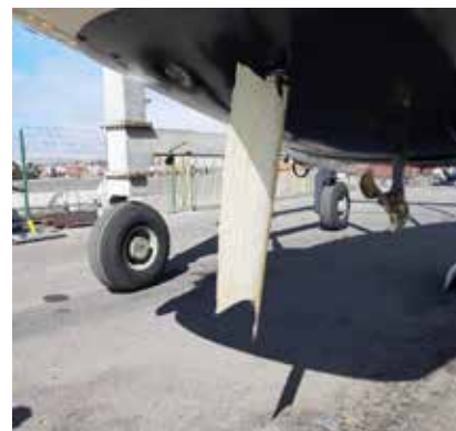
Figura 3- Leme do Sail La Vie após a interação com Orcas no dia 29 de Agosto de 2022- Créditos Tomás Barradas
